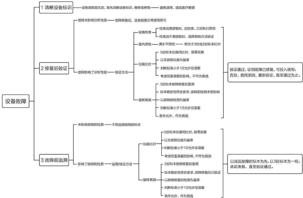
图1 仪器故障修复后的验证流程
